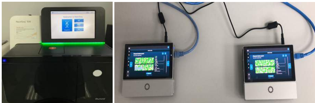
Imej 6.50 Peralatan Untuk Penjjukan Genom iaitu NexSeq500 (Illumina) Sequencer (kiri) dan MinION (Nanopore) Sequencing Devices (kanan))
